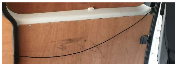
Image 1.6 – Slack side door cable
